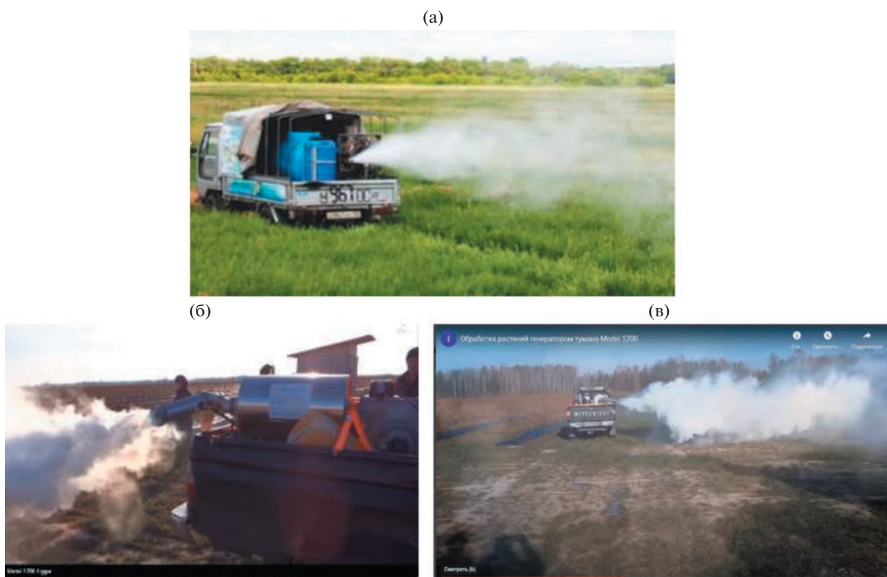
Рис. 6. Общий вид аэрозольной струи, создаваемой генераторами малой производительности, установленными в кузове автомобиля: (а) — газотермический генератор ГАРД — вид сзади слева, (б) — генератор холодного тумана Model 1200.
