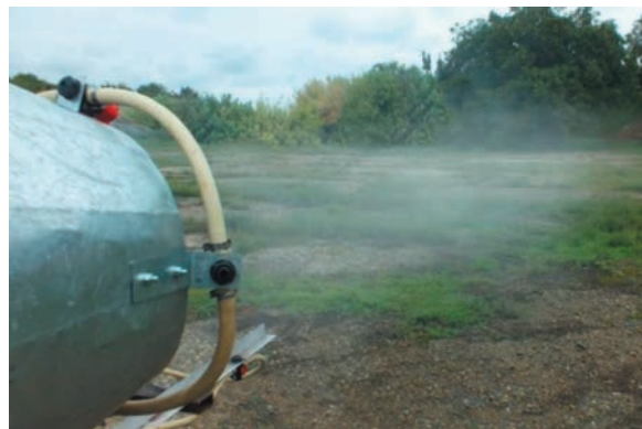
Рис. 8. Процесс инжектирования капель факелов распыла жидкости щелевых распылителей воздушным потоком струи и их транспортирование в форме воздушно-дисперсной системы.
