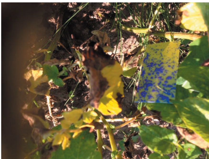
Рис. 3. Плотность покрытия при УМО с принудительным осаждением.
