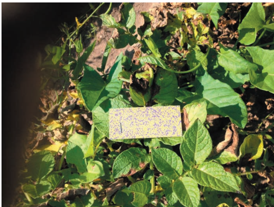
Рис. 2. Плотность покрытия при МО с инъекцией воздуха.
