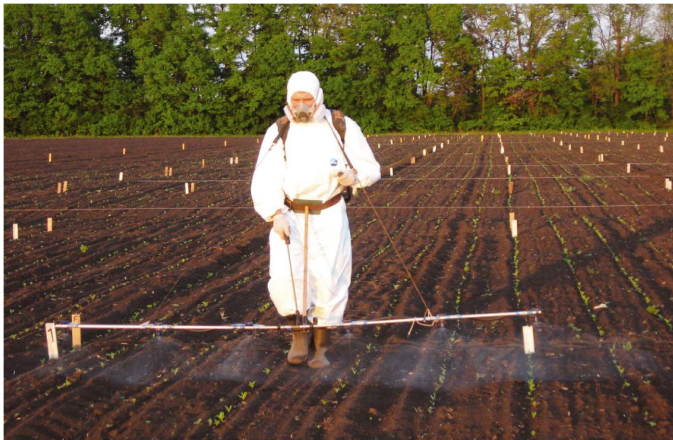
Рис. 1. Ранцевый опрыскиватель типа SOIO 425 (473Р), оборудованный штангой с 6-ю распылителями, рассчитанными на 6 рядков сахарной свеклы.
