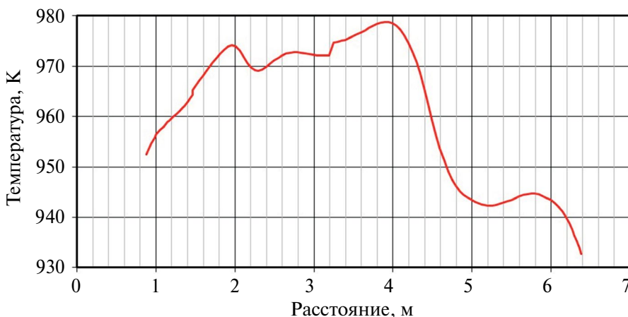
Рис. 14. Профиль температуры вдоль линии “в” — оси коллектора (2500 с расчета).
