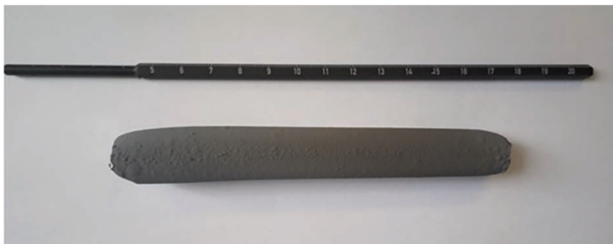
Рис. 1. Образец изотопно-обогащенного поликристаллического кремния-28.
