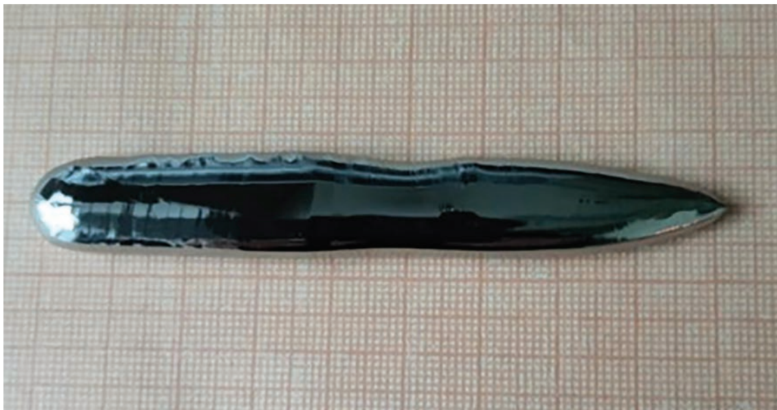
Рис. 3. Кристалл изотопно-обогащенного германия ^{72}\text{Ge} с содержанием основного изотопа ^{72}\text{Ge} на уровне 99.9%.
