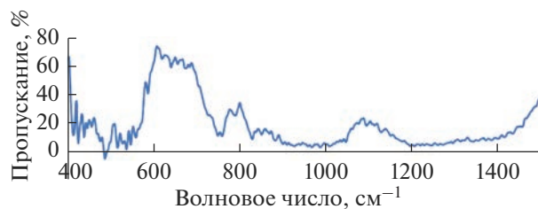
Рис. 3. ИК-спектр плава, взятого из расплава \text{CaCl}_2\text{--CaO--B}_2\text{O}_3\text{--Gd}_2\text{O}_3 .
