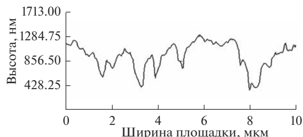
Рис. 2. Профилограмма поверхности кварцевых стержней.
