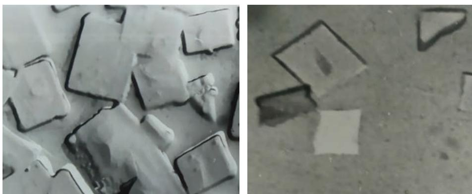
Рис. 6. Микрофотографии синтезированного образца  $MgAl_2O_4 + 1.5\% Eu_2O_3$ ;  $\times 4500$ .
