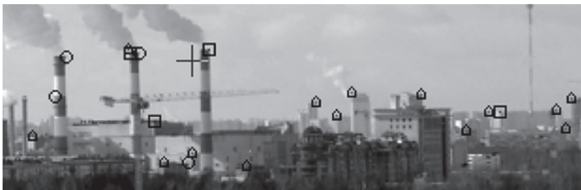
Рис. 4. Результаты обработки изображения промышленно-городской сцены алгоритмом детектирования характерных точек
