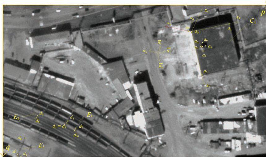
Рис. 4. Изображение здания, эталонных объектов, разметка опорных точек
