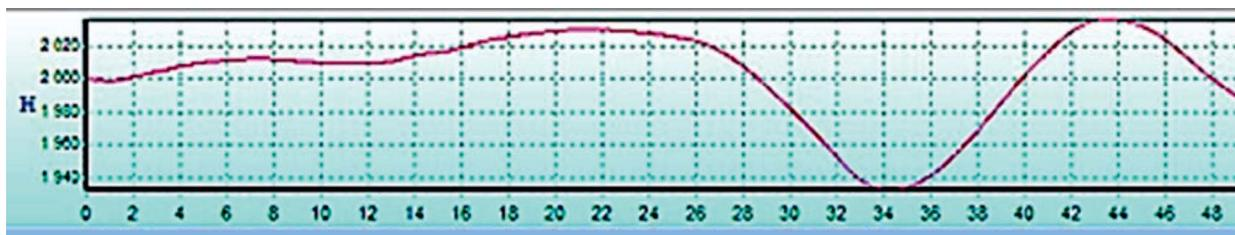
Рис. 2. Отклонения по высоте при летном испытательном маневре при постоянном режиме работы двигателя.
