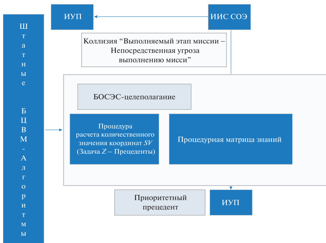
Рис. 1. Использование метода решения задачи по прецеденту в базе знаний БОСЭС-целеполагание: блоки базы знаний БОСЭС-целеполагание и ее взаимодействие со штатными бортовыми алгоритмами, реализованными в бортовых цифровых вычислительных машинах (штатные БЦВМ-алгоритмы), ИИС СОЭ и информационно-управляющем полем (ИУП) кабины экипажа
