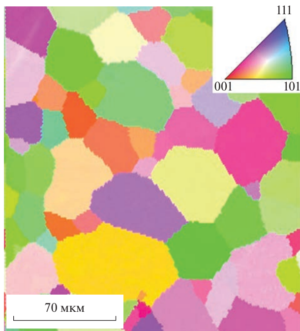
Рис. 1. Ориентационная ДОРЭ-карта ниобия, отожженного при 1123 К.
