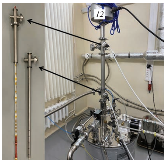
Рис. 3. Шток и труба крепления элементов КП в шахте криостата — слева, криомагнитная система 10 Тл — справа.
