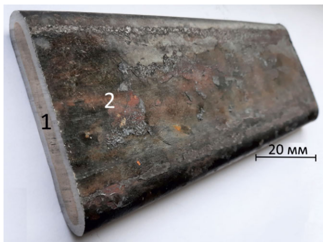
Рис. 1. Внешний вид сэндвич-пластины: 1 – композит; 2 – стальная оболочка.
