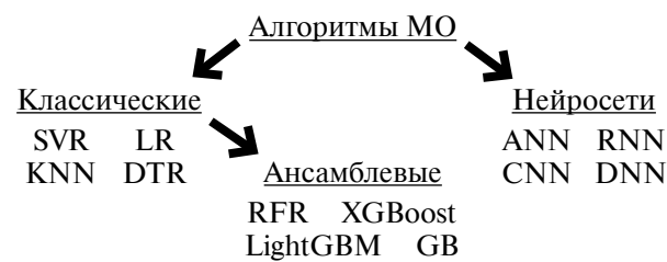
Рис. 3. Классификация алгоритмов машинного обучения для решения задач регрессии.
