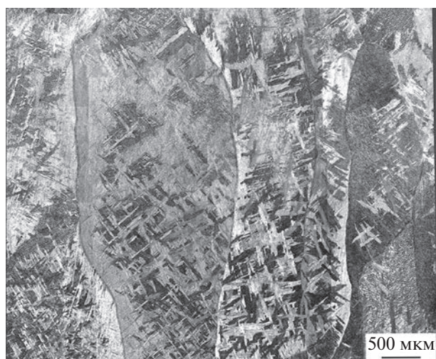
Рис. 1. Оптическое изображение микроструктуры 3D-напечатанного сплава Ti-6Al-4V.
