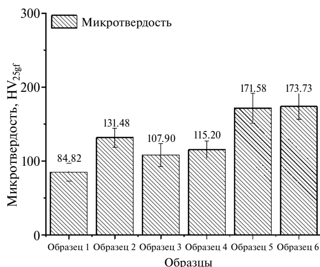
Рис. 8. Измеренные значения микротвердости образцов.
