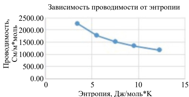
Рис. 15. Зависимость поверхностной электропроводимости от величины энтропии.
