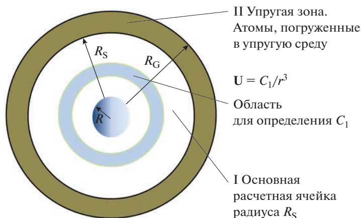
Рис. 1. Схема расчетной ячейки в окрестности поры радиуса R (сечение для z = 0 ). R_G — общий радиус зоны вычислений.
