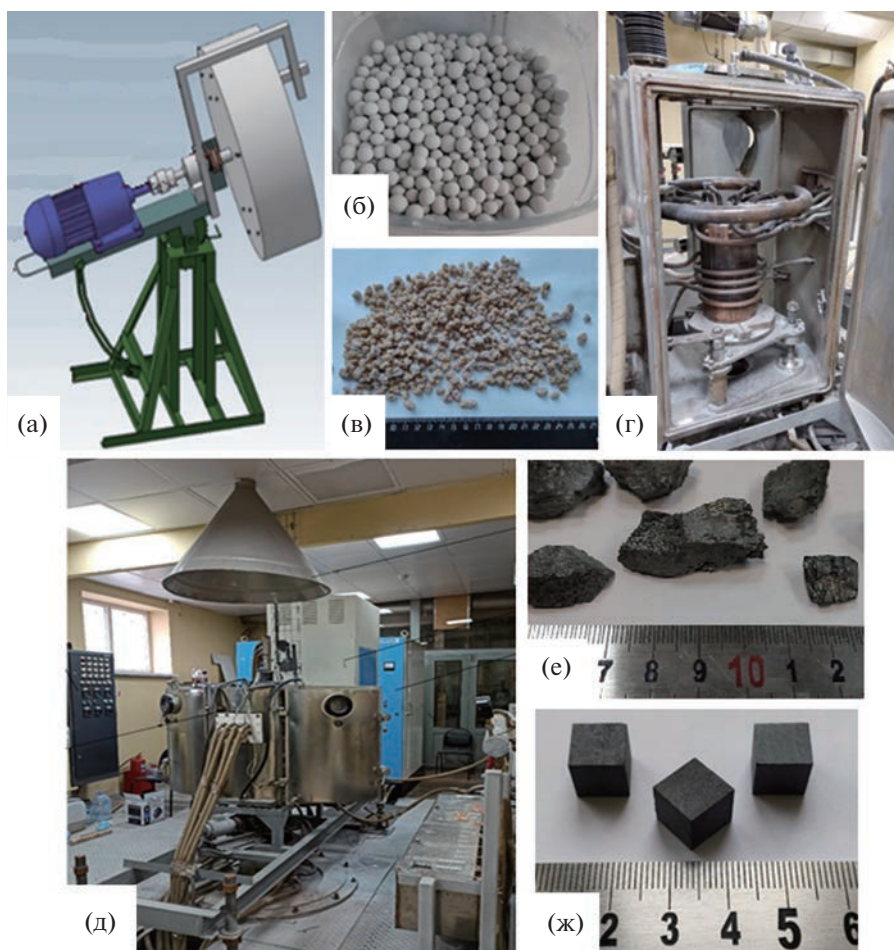
Фиг. 5. Установка для грануляции (а); гранулы шихты (б, в); “холодный” тигель (г) и вся установка ИПХТ (д); подготовленные для изучения образцы керамических матриц (е, ж).
