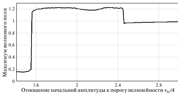
Рис. 2. Зависимость максимума волнового поля от отношения начальной амплитуды к величине порога нелинейности.
