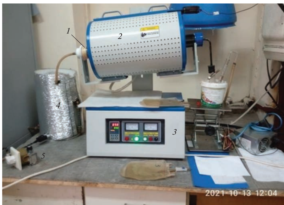
Рис. 1. Установка активации: 1 – реактор, 2 – трубчатая печь, 3 – блок управления, 4 – парогенератор, 5 – регулятор напряжения парогенератора.
