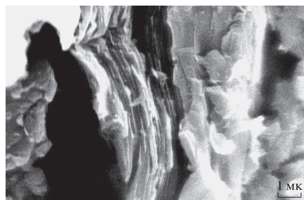
Рис. 3. Графеновые нанопластинки, прослоенные каменноугольным пеком.
