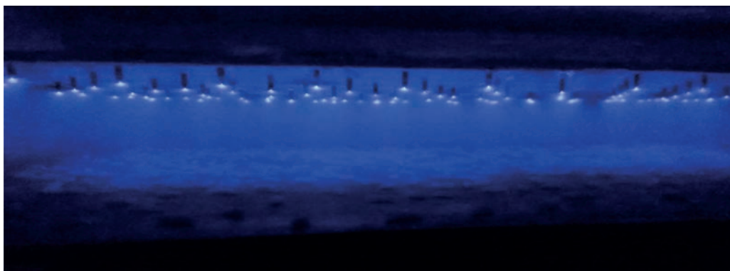
Рис. 1. Плазменная обработка рисовых зерен в ТРАД. Межэлектродное расстояние d = 2 см.
