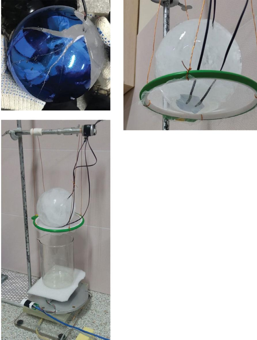
**Рис. 2.** Этапы эксперимента: замораживание воды в пластиковой форме с термодатчиком в центре в морозильной камере, отделение пластиковой формы, взвешивание леяного шара, его фиксация над стаканом для сбора талой воды, непрерывное измерение массы талой воды и температуры как внутри, так и снаружи леяного шара.
