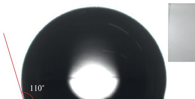
**Рис. 9.** Снимок капли воды на поверхности ОСП на основе кремнийорганического лака КО-921, модифицированного 17 масс. % ПДМС и 20 масс. % эпоксидной смолы, через 16 месяцев экспозиции в субэкваториальном климате. На врезке: фотоснимок покрытия, на котором измерен угол смачивания водой.
