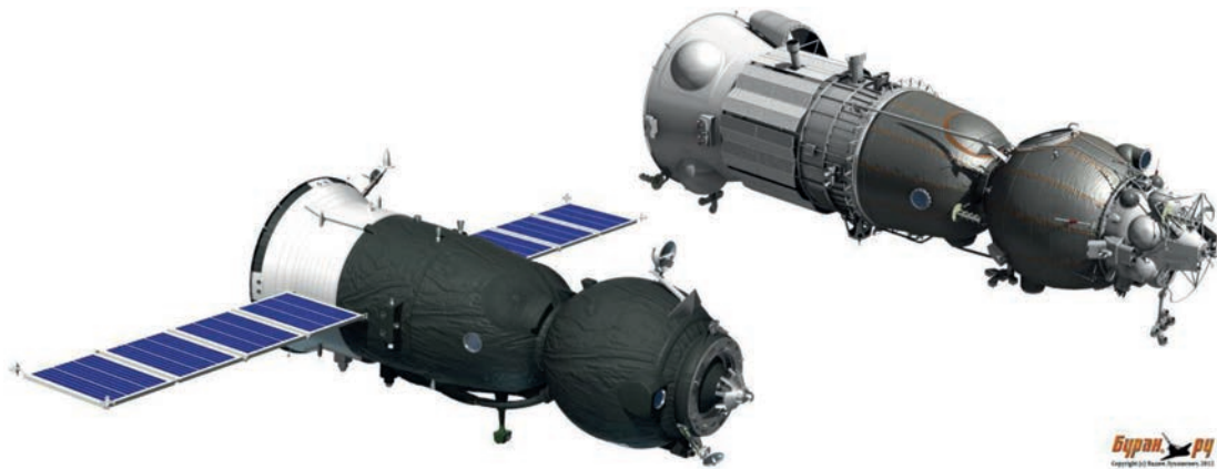
Рис. 6. Лунный орбитальный корабль (ЛОК) (РКК “Энергия”).
