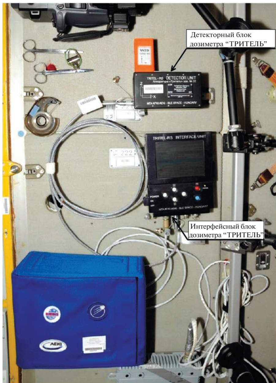
Рис. 1. НА “ТРИТЕЛЬ”, установленная на панелях 221 и 222 Служебного модуля МКС.
