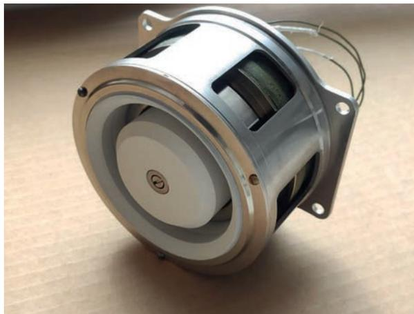
Рис. 1. Модель двигателя СПД-70.
