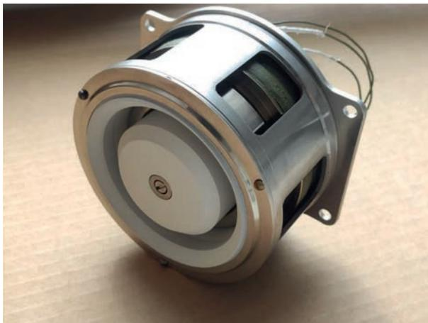
Рис. 1. Модель двигателя СПД-70.
