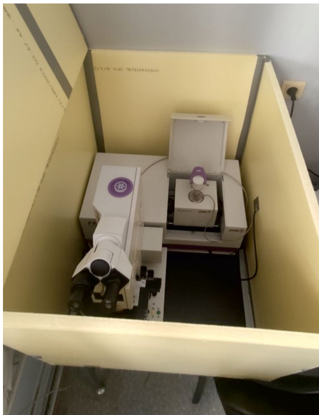
Рис. 4. Внешний вид ИК-Фурье спектрометра FT-801 после доработки.
