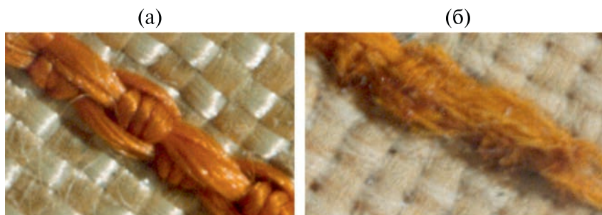
Рис. 5. Изображения шва из арамидных нитей до (а) и после (б) воздействия на лабораторном стенде АК с эквивалентным флюенсом 8 \cdot 10^{21} \text{ см}^{-2} (размер изображений 1.5 \times 1.0 \text{ мм} ).
