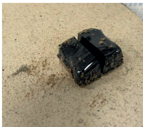
Рис. 7. Образец простой геометрии из порошка габбро-диабазы на керамической подложке.
