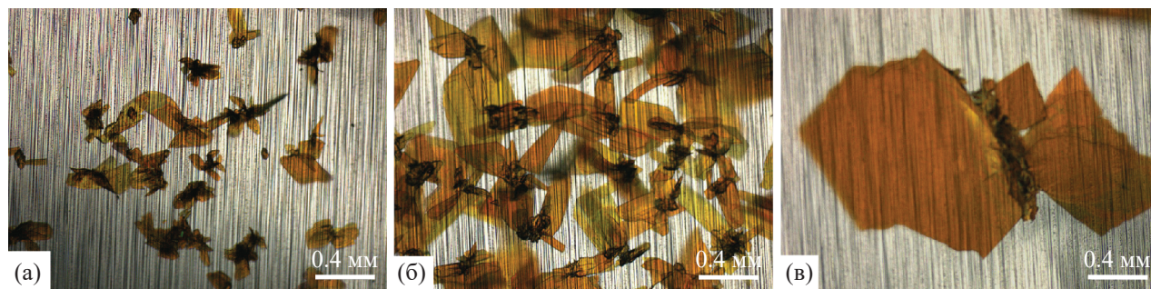
Рис. 6. Изображения кристаллов тетрацена, выращенных при разных температурах источника T_S : 513 (а), 533 (б) и 553 К (в).
