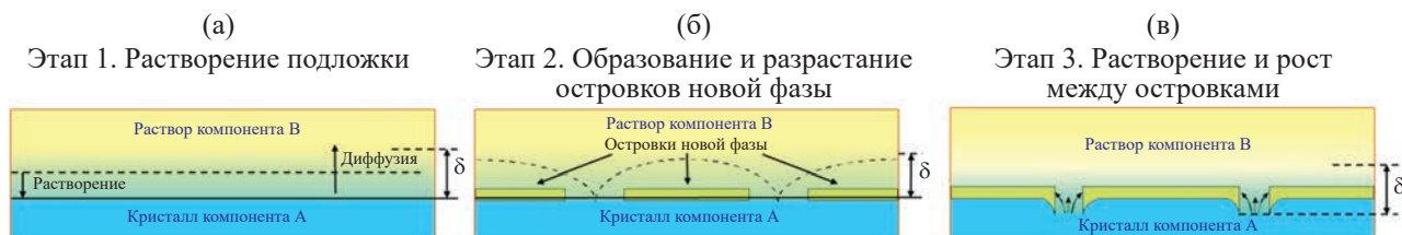
Рис. 4. Этапы формирования эпитаксиальных структур: а — начальное растворение подложки, б — осаждение островков, в — дальнейший рост островков в процессе растворения подложки [57].
