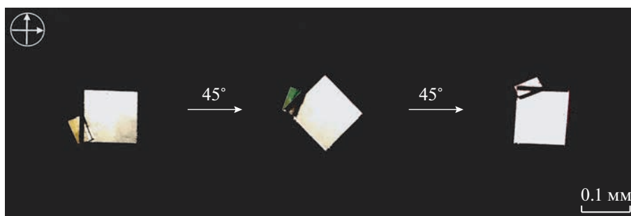
Рис. 6. Изменение интенсивности поляризованного света при прохождении через грань (001) монокристалла tBu-3P-tBu при различных положениях относительно скрещенных поляризаторов (при переходе слева направо кристалл поворачивается на 45° по часовой стрелке).
