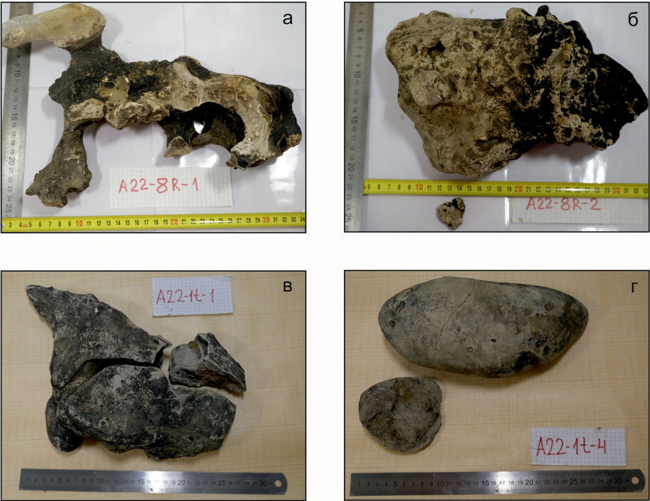
Рис. 4. Карбонатные образования хребта Гаккеля, цемент которых представлен арагонитом (а, б) и магниальным кальцитом (в, г).
