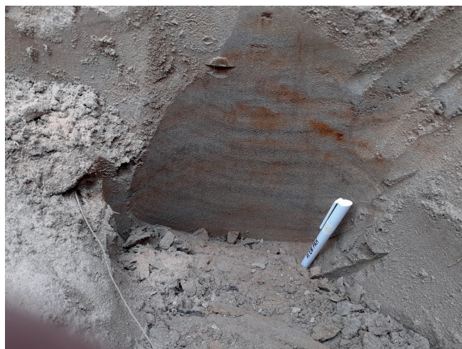
Рис. 4. Продуктивный пласт Итмановской россыпи: темные прослои содержат повышенные концентрации рудных минералов — ильменита, рутила, хромита и циркона.
