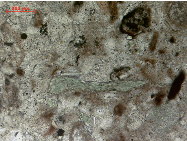
Рис. 2. Биотит практически полностью хлоритизированный (образец 3076, скважина 1038А), петрографический шлиф (никולי параллельны).
