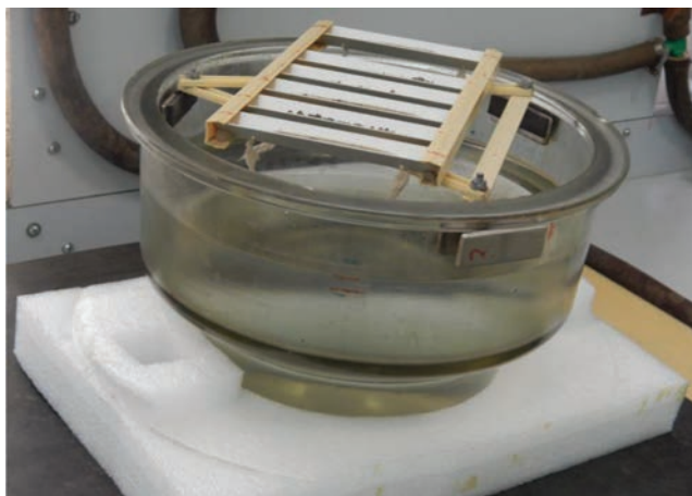
Рис. 3. Фото устройства для определения устойчивости почвенных агрегатов.
