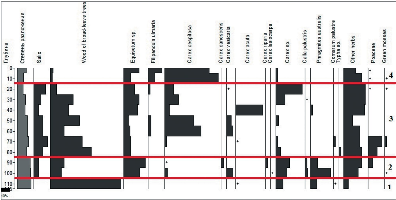
Рис. 2. Стратиграфическая диаграмма болота Подкосьюмово (эвтрофный этап: 1 – древесная, 2 и 3 – древесно-травяная, 4 – осоковая стадии).
