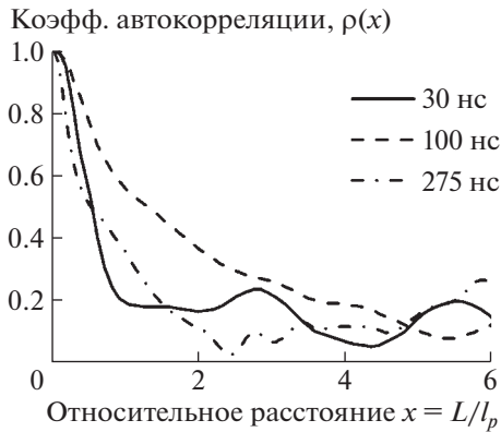
Рис. 1. Коэффициенты автокорреляции рефлектограмм в зависимости от относительного расстояния, нормированного к пространственной длительности зондирующего импульса, для значений длительности импульса 30 нс, 100 нс, 275 нс.
