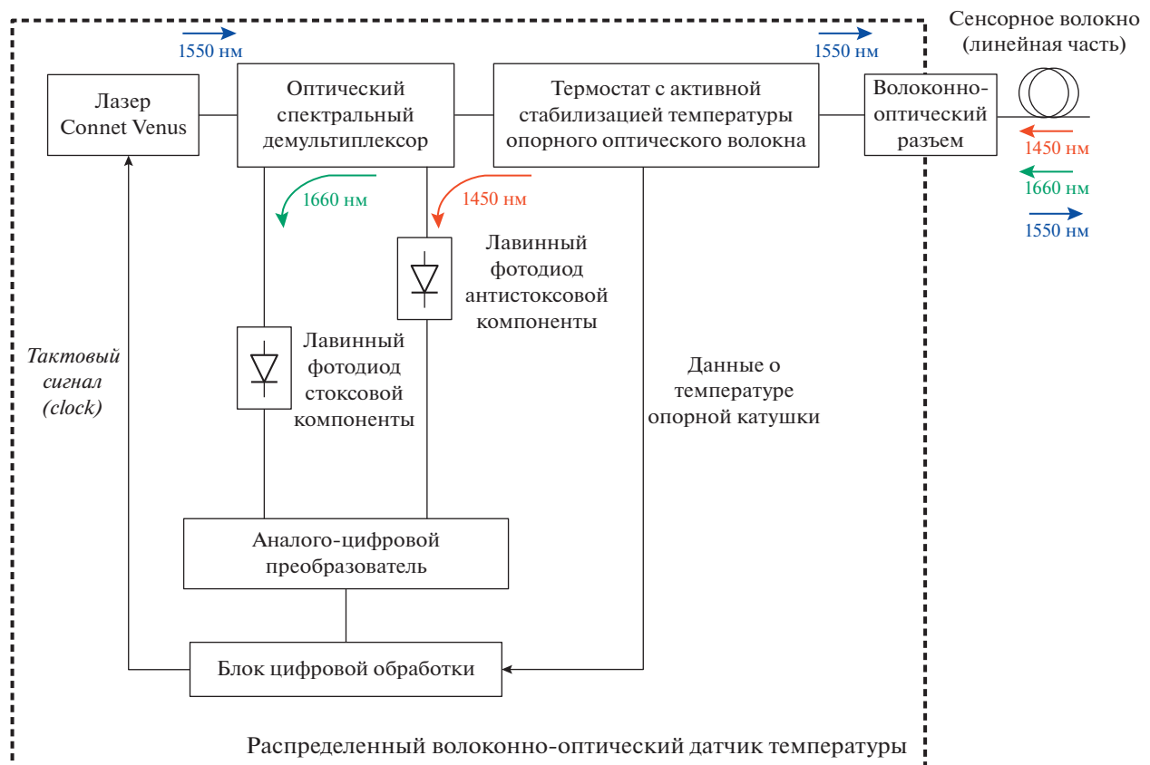
Рис. 3. Схема распределенного волоконно-оптического датчика температуры.
