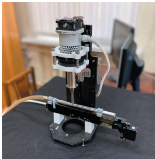
Рис. 1. Внешний вид устройства для ультразвуковой сварки трубок из лавсана с резистивным DLC-покрытием.
