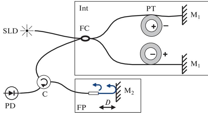
**Рис. 1.** Схема детектирования: SLD – широкополосный источник света; FC – светоделиватель 50 : 50; Int – опорный интерферометр; PT – пьезокерамические катушки с намотанным волокном;  $M_1$ ,  $M_2$  – зеркала; C – оптический циркулятор; FP – резонатор Фабри–Перо; PD – фотоприемник;  $D$  – оптическая длина чувствительного элемента сенсора.
