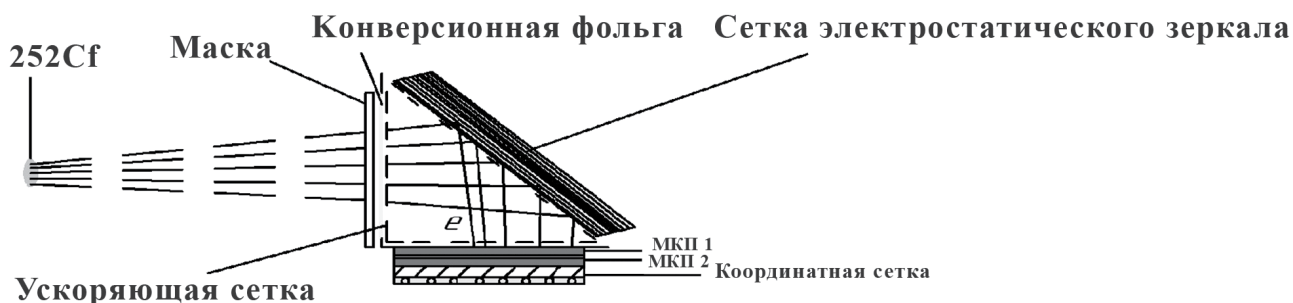
Рис. 3. Схема работы ПЧД.
