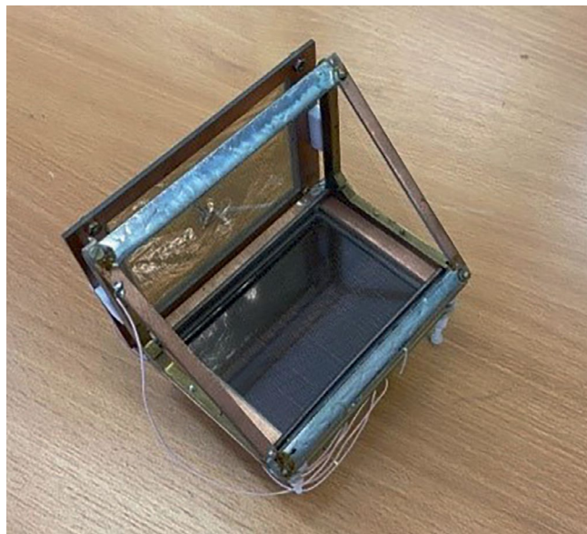
Рис. 2. Позиционно-чувствительный детектор на основе МКП.
