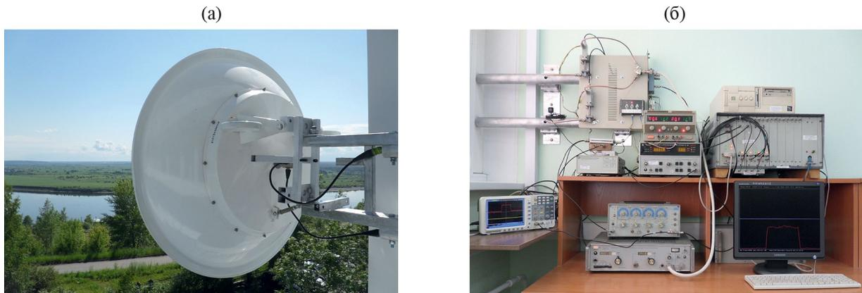
Рис. 4. Внешний вид приемного устройства экспериментальной установки: а – зеркальная антенна с ЛПР, б – двух-канальное приемное устройство ортогонально-поляризованных сигналов.
