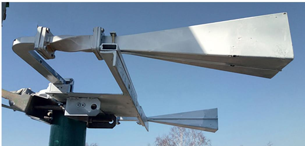
Рис. 3. Внешний вид передающих рупорных антенн.
