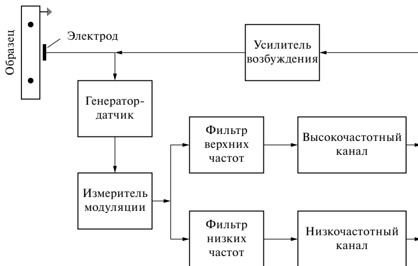
Рис. 6. Блок-схема установки для измерения внутреннего трения и модуля упругости на двух частотах.
