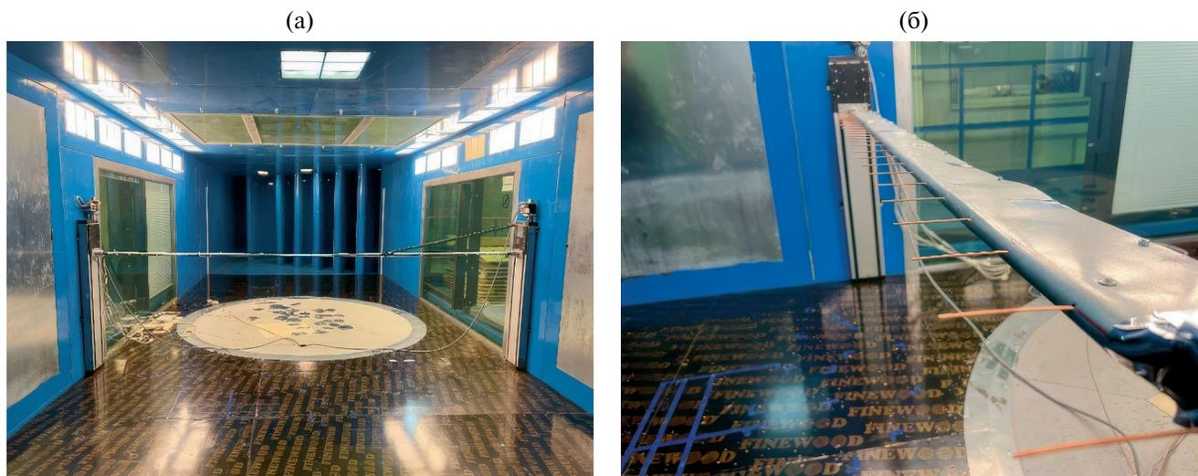
Рис. 1. Специализированная гребенка для проведения измерений, установленная на координатном устройстве.
