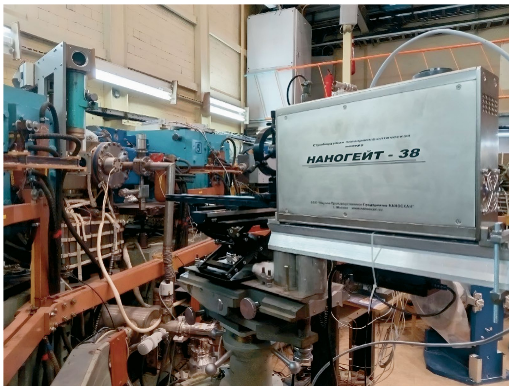
Рис. 3. Внешний вид камеры Наногейт-38 в составе оптической диагностики для измерения поперечного профиля пучка в бустере БЭП.
