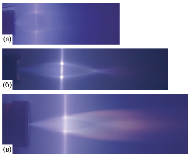
Рис. 1. Визуализация сверхзвуковой струи аргона, истекающей из звукового (а) и сверхзвукового (б, в) сопел в условиях отсутствия (а, б) и развитой конденсации в потоке (в).
